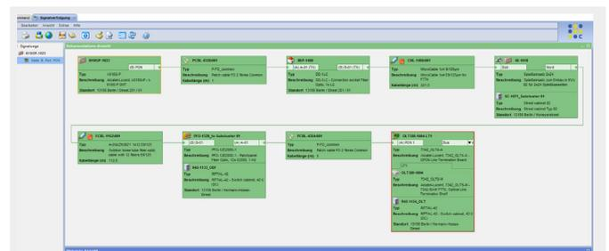
Abb.: Signalverfolgung zur detaillierten Auswertung aller verbundenen aktiven und passiven Komponenten
