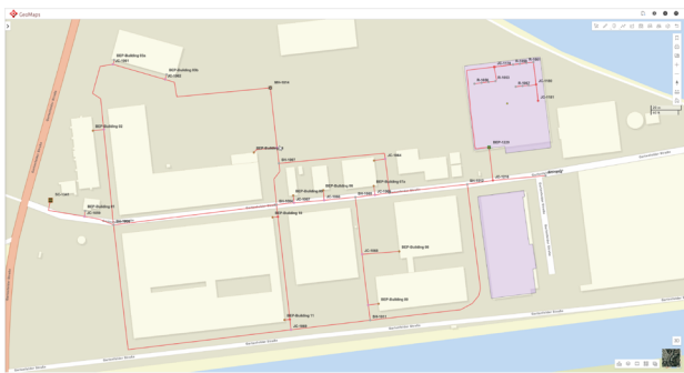
Eine GIS-Applikation macht CIs aus der CMDB in Kabelnetzen transparent und zeigt Infrastrukturobjekte georeferenziert auf Karten an.
