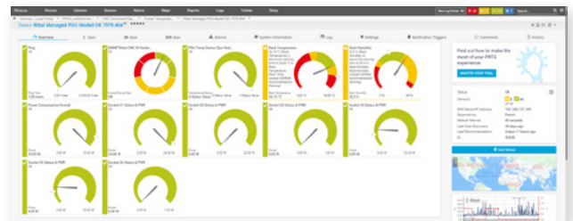
DCIM-Infrastruktur-Dashboard mit Überwachung von Temperatur, Luftfeuchtigkeit und Stromverbrauch (gesamt und je Stromanschluss).
